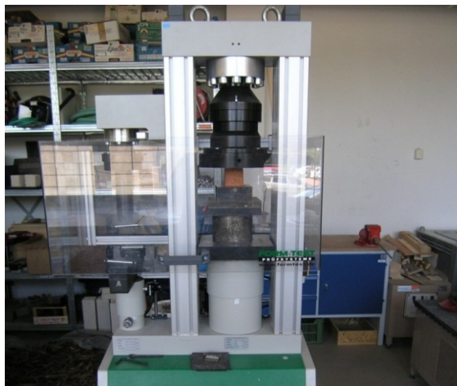
Obr. č. 59: Zkouška pevnosti v tlaku
