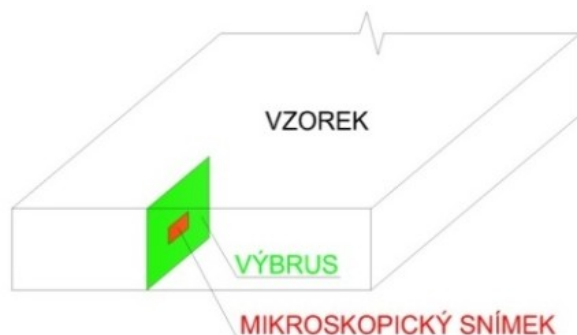
Obr. č. 60: Přehled kroků pro zhotovení mikroskopického snímku výbrusu (vzorek → výbrus → mikroskopický snímek)
