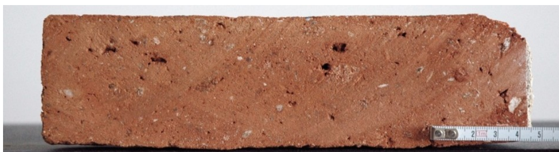
Obr. č. 53: Řez vzorku 14113 (V4)
