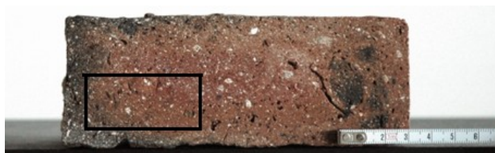
Obr. č. 65: Místo odběru vzorku pro výbrus z cihly 14112 (V3)
