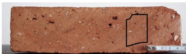
Obr. č. 67: Místo odběru vzorku pro výbrus z cihly 14113 (V4)
