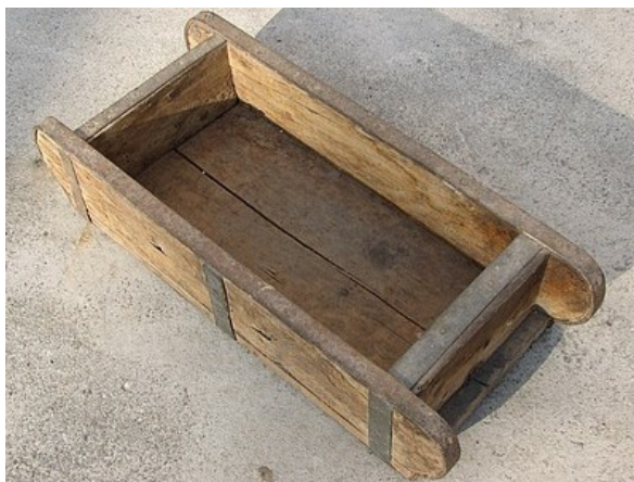
Obr. č. 6: Dřevěná forma pro výrobu cihel [33]
