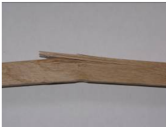
Obr. 8: Částečné porušení vzorků listnatého řeziva
