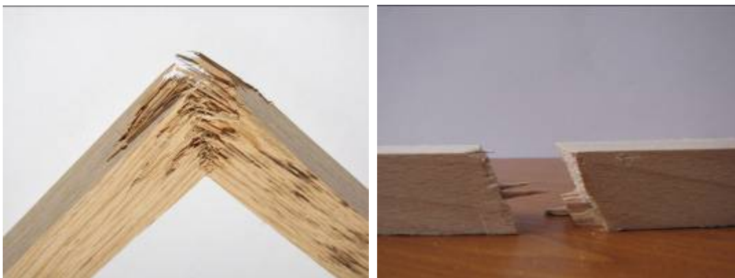
Obr. 6, 7: Typické porušení vzorků bukového a dubového řeziva
